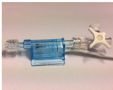
Figur 1: Tryckgivare i form av membransensorer av engångstyp (bild respektive principskiss).
